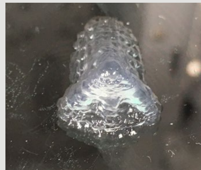
• De metoder Chunlin Xu arbetar med att ta fram gör det möjligt att göra 3D-utskrifter med biomaterial. Den här nässtrukturen är en 3D-utskrift av nanocellulosa.
