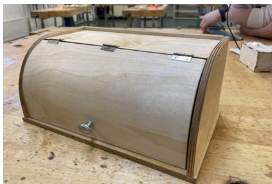
Elever i åk 9 har övat på att formpressa fanér. Till vänster en av produkterna, en brödlåda med böjd trälucka. Foto: Kasper Hiltunen
