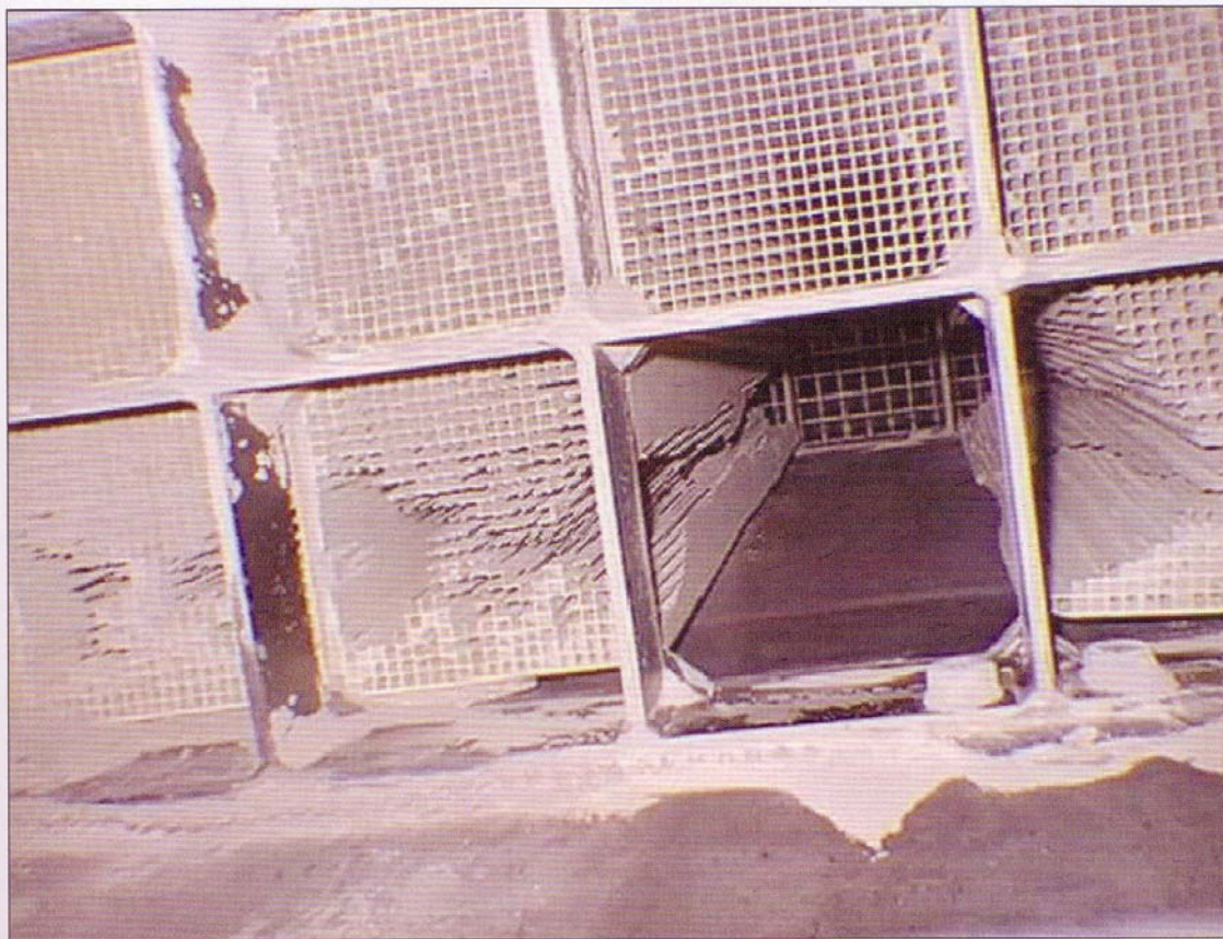
Bild 2. Zerstrahlte Katalysatorsteine und leere Hülse.
